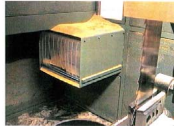
Naar binnen gekeerde uitvoertunnel met vier achter elkaar geplaatste kunststof gordijnen.
